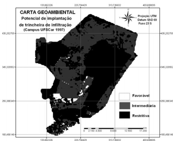
**Figura 5 - Áreas potenciais para implantação de estruturas de infiltração no campus da UFSCar.**
