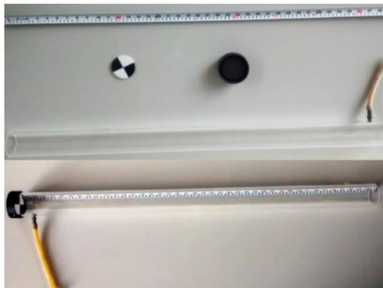
**Figura 1 – Peças do tubo de turbidez separadas e tubo montado**
