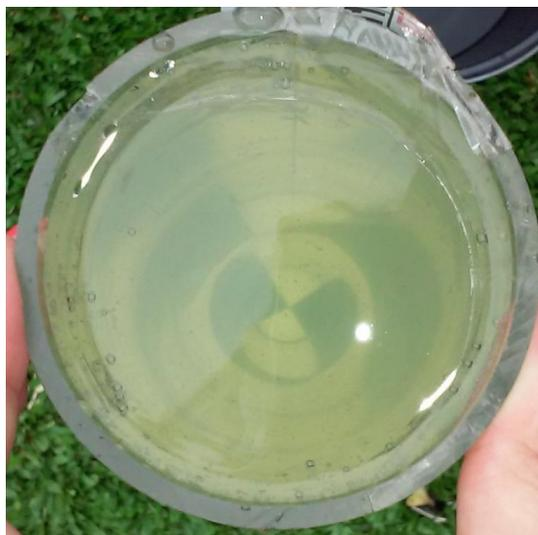
**Figura 8 – Medida realizada em campo com amostra de água com turbidez de 8 NTU, evidenciando o alvo ainda visível, de modo que não é possível realizar uma leitura**
