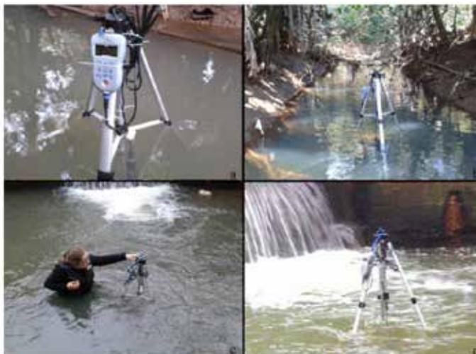
**Figura 2 - Imagem parcial do local (Lajeado do Pardo) usado nas avaliações do tempo de estabilização da sonda multiparâmetros, (a e b) tempo de estabilização no regime laminar; (c e d) tempo de estabilização no regime turbulento, Frederico Westphalen, maio 2015. Fonte: Autora**
